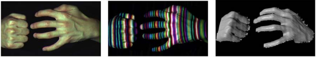
Figura 2.5: Digitalización mediante la proyección de luz estructurada multicolor.
