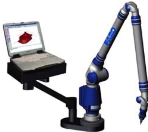
Figura 2.2: Representación de un equipo de digitalización mediante brazo articulado.
