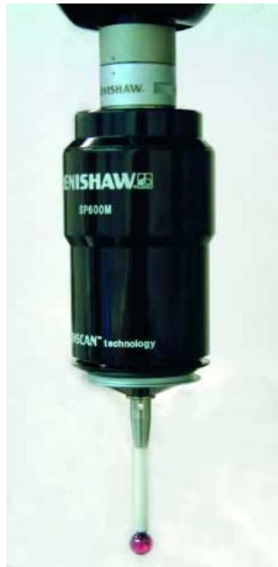
Figura 2.1: Imagen de una cabezal de digitalización en continuo SP 600 de Renishaw
