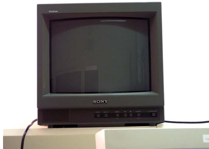
Figura 7.11: Monitor de video Sony PVM-14L1 utilizado para visualizar la señal de video del escaner
