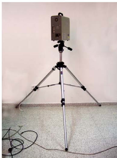
Figura 7.5: Imagen del conjunto formado por trípode, la cabeza de rotación y el escáner.
