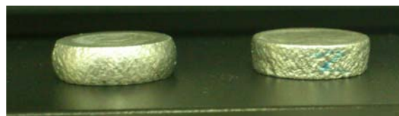
Figura 2.5. Fotografía de las probetas de altura 10 mm de AA 6082-T6 ensayadas incrementalmente y de manera continua
