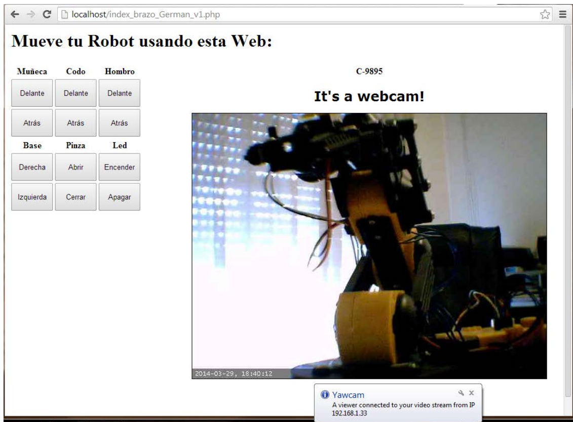
Figura 4.32. Streaming de vídeo usando Yawcam con indicación de la IP de conexión del espectador conectado.
