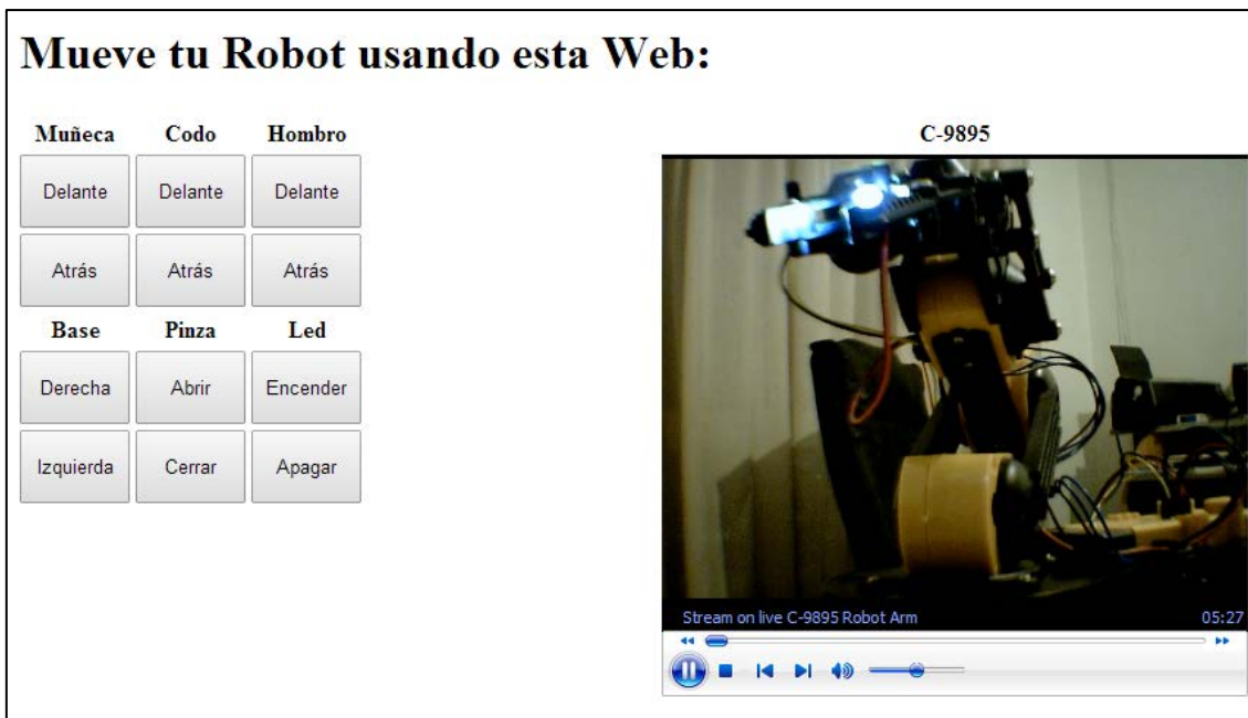
Figura 6.2. Interfaz de uso del brazo robotizado en el proyecto TechnoMuseum.
