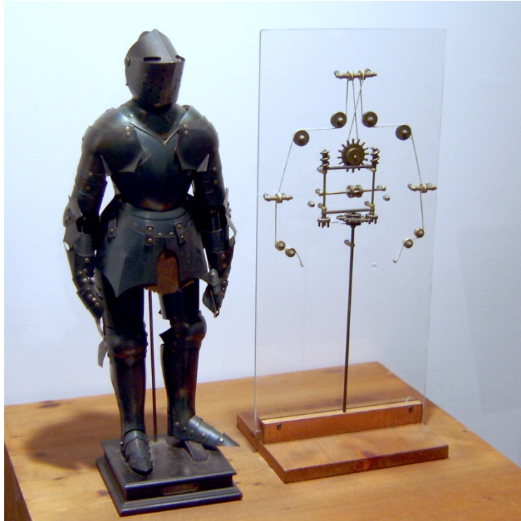
Figura 2.1. Caballero mecánico de Leonardo Da Vinci, reconstruido por Mark Rosheim en 2002. Museo de Leonardo en Florencia.
