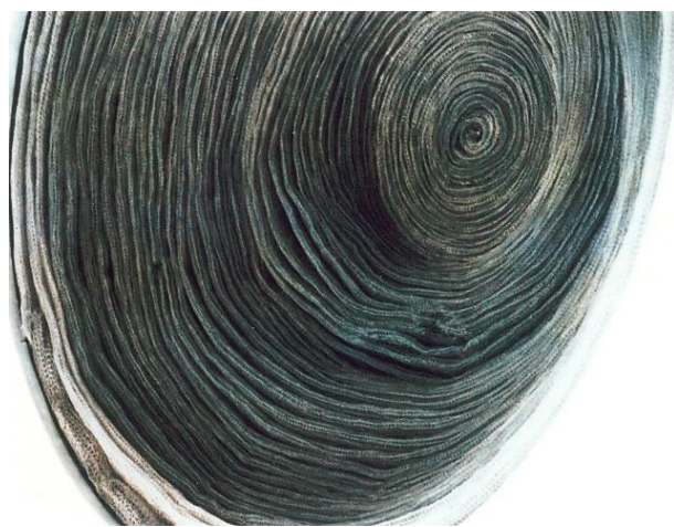
Fig. 2-7. Imagen del absorbedor Sulzer 2 (fuente: [71])
