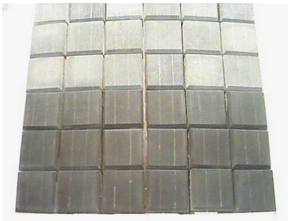
Fig. 2-41. Configuración 2 del receptor SOLAIR 200: copas superiores de SiSiC, copas inferiores de re – SiC (fuente: [119])
