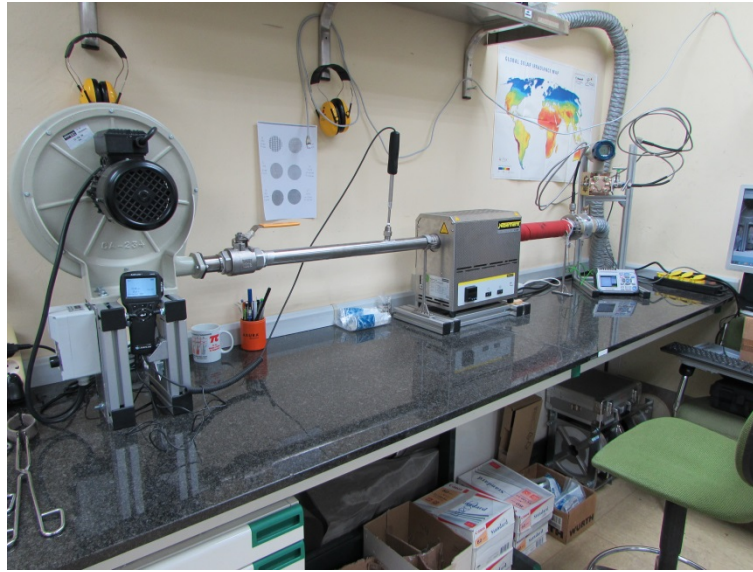
Fig. 4-1. Instalación experimental para la medida de la caída de presión.
