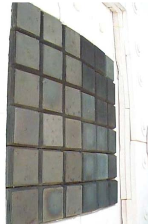
Fig. 2-42. Configuración 3 del receptor SOLAIR 200: láminas en la mitad izquierda, de la configuración 2 (fuente: [119])
