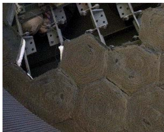
Fig. 2-14. Absorbedor TSA. Detalle de módulos frontal (fuente: [42])
