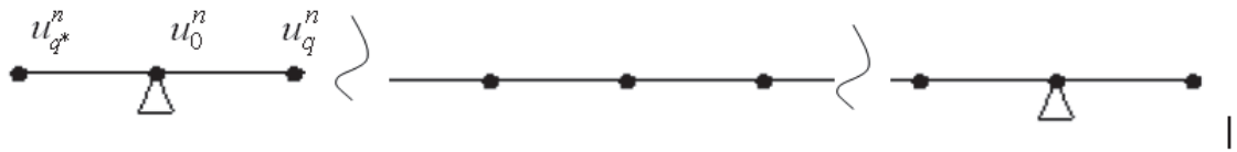
Figura 5.3: Esquema de los nodos de la viga con los nodos ficticios
