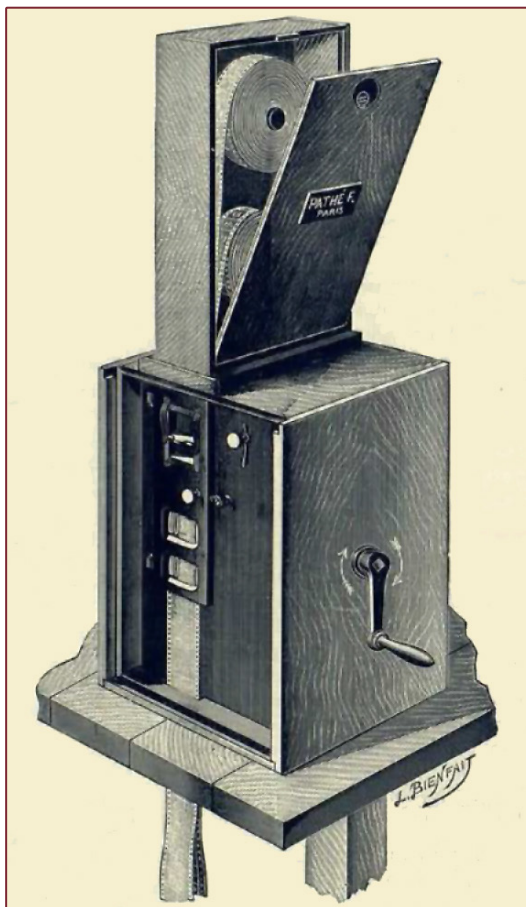
ILUSTRACIÓN 15 (arriba).- SISTEMA DE ARROLLADO DEL NEGATIVO PARA LA LABORATORIO.
