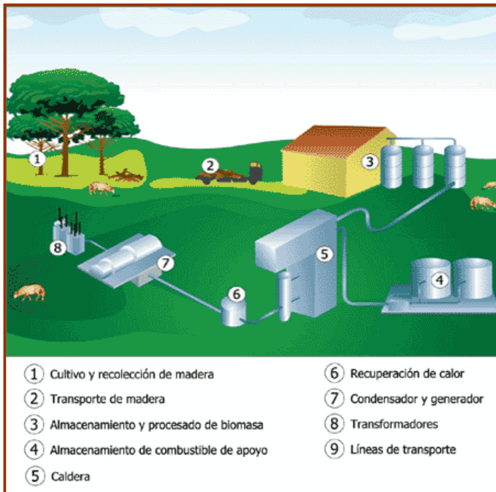
Figura 322: Distintas fases del proceso de transformación energética en la planta de biomasa
