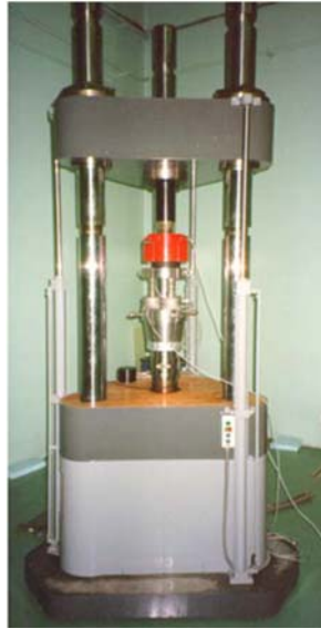
Figura 1.8. Esquema y foto de la máquina de fuerza hidráulica y sistema Build-up en el CEM (Robles Carbonell et al., 1998).
