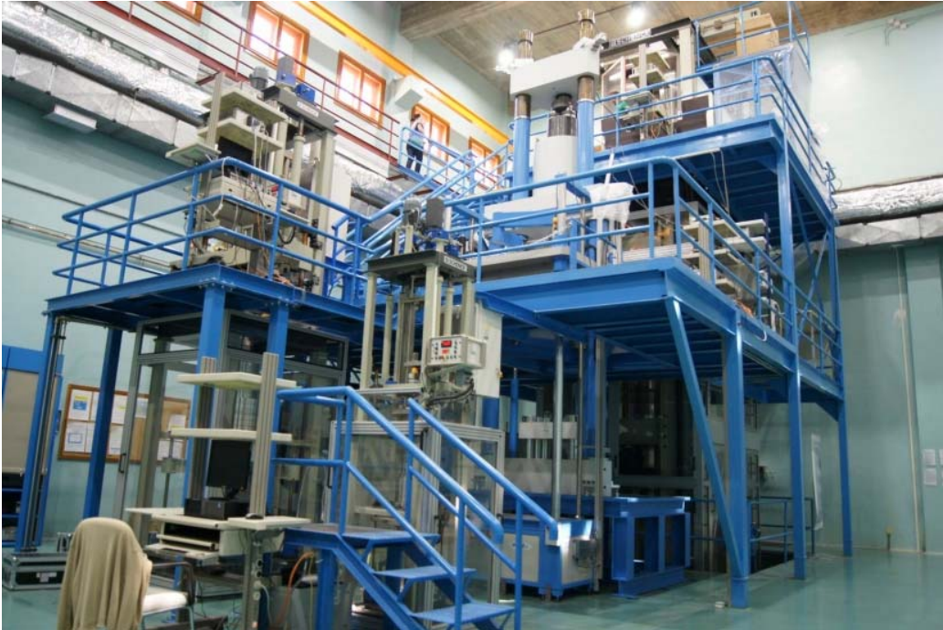
Figura 1.7. Máquinas patrón de fuerza de carga directa (y nueva máquina de fuerza hidráulica de 10 MN en desarrollo) en el CEM.
