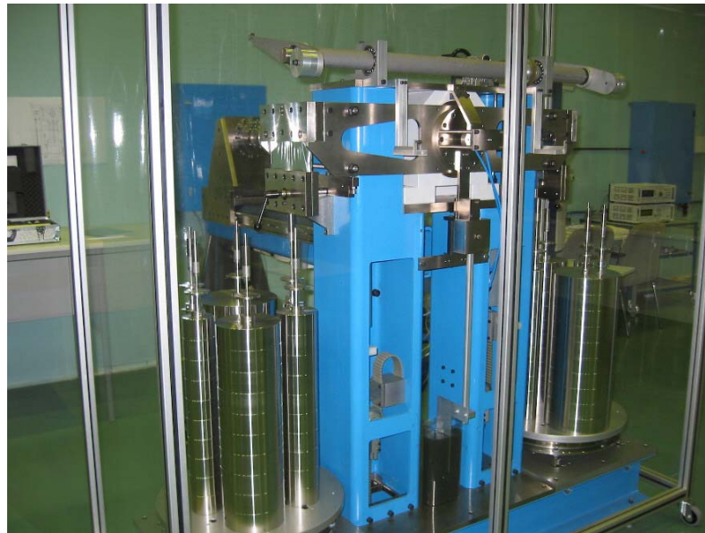
Figura 1.11. Máquina patrón de par de carga directa en el CEM
