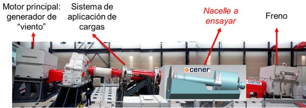
Figura 2.1 Componentes de un banco de ensayos de nacelles (Fotografía por cortesía de CENER)
