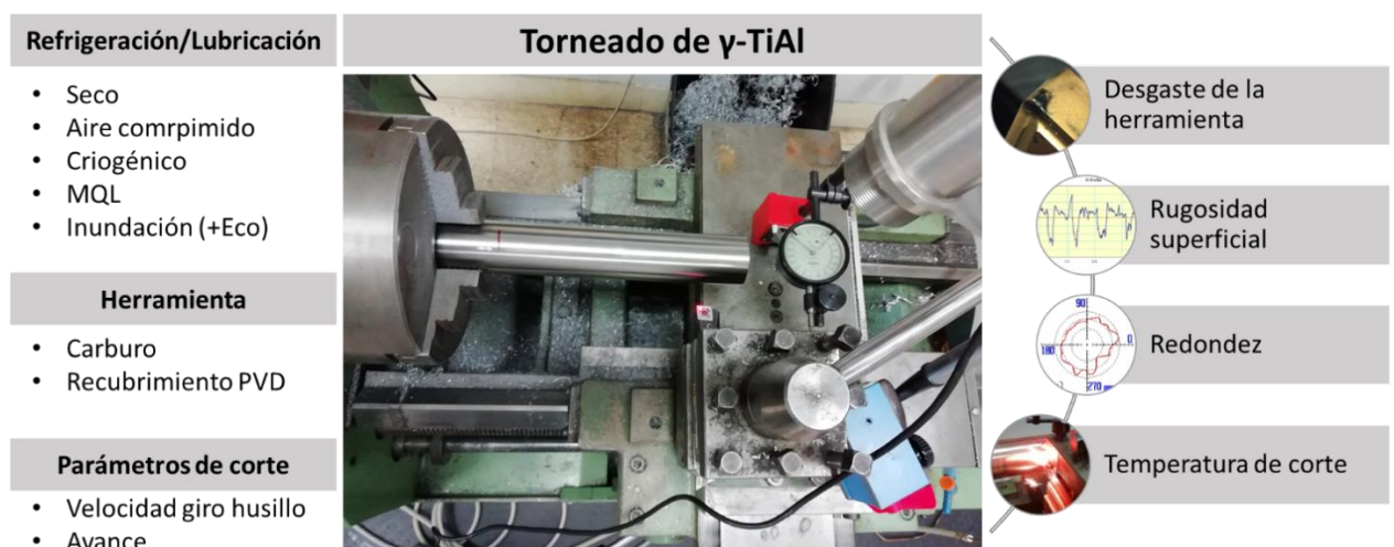
Figura 7. Operación de torneado como sistema tribológico.
