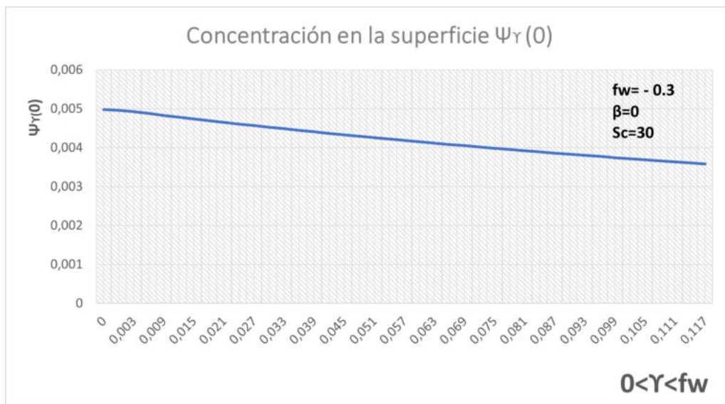
Figure 4.23: Evolución de la \Psi_\gamma(0) respecto a \gamma para una superficie plana y un soplado f_w = -0.3 .
