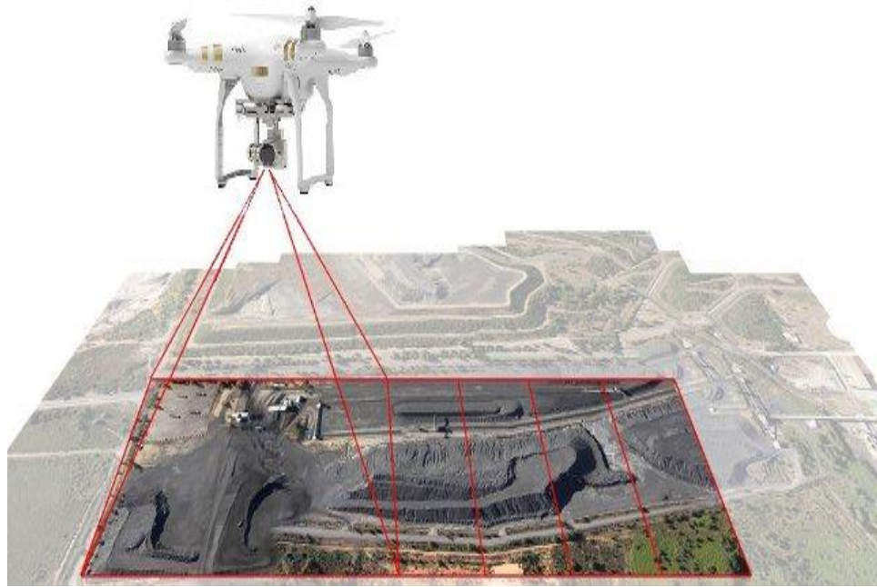
Figura 6.39: Ejemplo de fotogrametría aérea con drones. (Tomado de www.ciptecin.com ).
