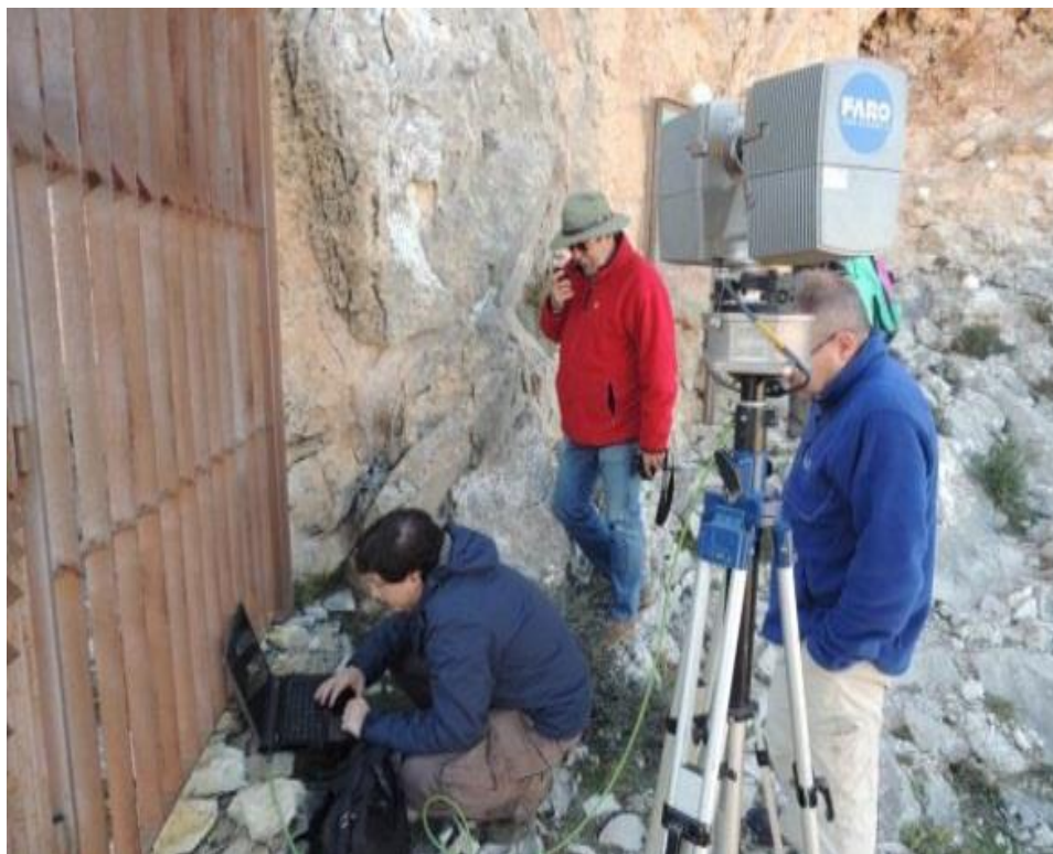
Figura 6.55: Escaneado y registro de datos en 3D de un yacimiento. Cueva de los Letreros en Vélez-Blanco (Almería). Proyecto Velad. Año 2015. (Imagen del autor).
