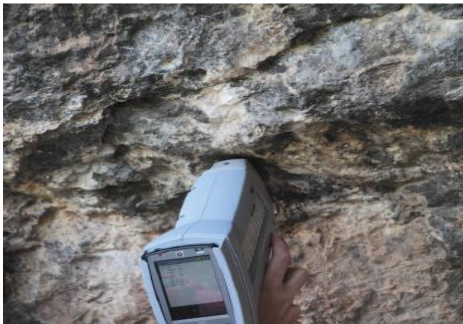
Figura 7.30: Equipo portátil de EDXRF usado en el panel de Cañaica del Calar II. (Tomado de Ruiz, J. F. et al., 2016).
