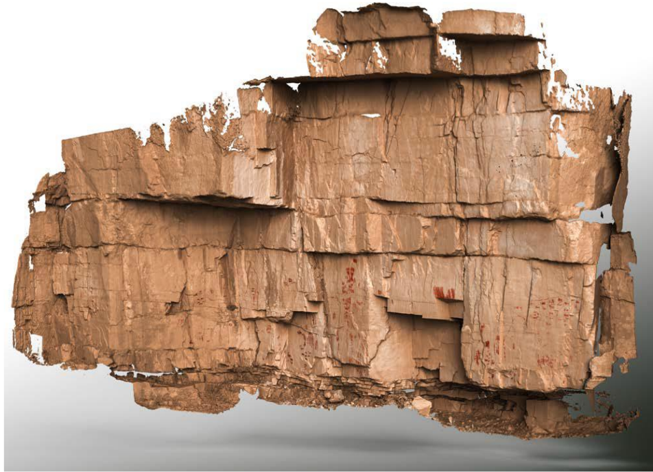
Figura 6.63: Modelo 3D renderizado en Adobe Photoshop del Canchal de las Cabras Pintadas I (La Alberca, Salamanca), texturizado con la reproducción digital obtenida a partir de su textura en formato ortofoto adaptativa generada en Agisoft Metashape. (Tomado de Ruiz, J. L., 2019).
