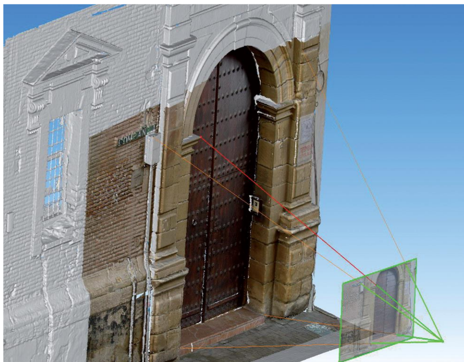
Figura 4.4: Documentación geométrica del patrimonio cultural. Iglesia del Santo Cristo de la Salud de Málaga (España). Autoría: TCA Cartografía y Geomática S. A. (Tomado de Muñoz, V. et al., 2017).
