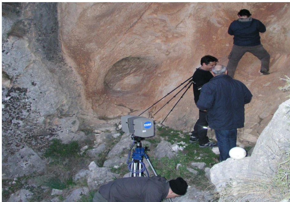
Figura 6.49: Trabajo de documentación en Fuente de los Molinos con Escáner láser 3D. Proyecto Velad. Vélez Blanco (Almería). Año 2015. (Tomado de colección Ripoll, S.).
