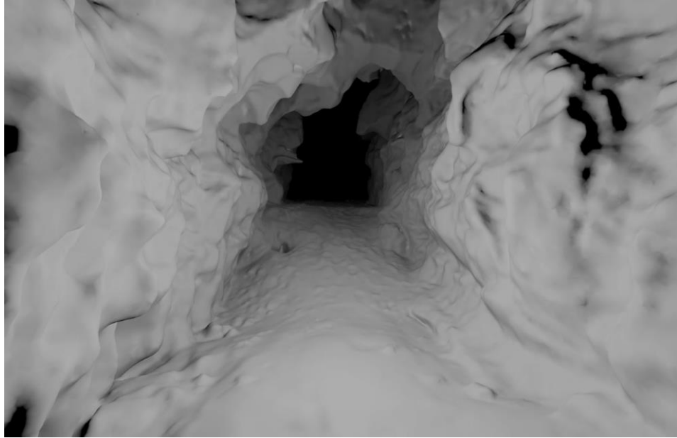
Figura 6.51: Cueva de El Reno (Guadalajara), modelado de la nube de puntos para conseguir superficies rocosas (Tomado de Bayarri, V. Gim-Geomatics, Proyecto SIGAREP I).
