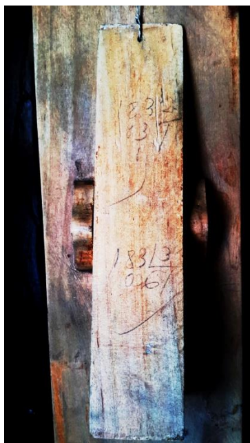
Figura 122 a y b. Cálculos realizados a mano en la cuña del Aparato de la cuña de Frick e imagen del instrumento (LDV/05/0030). Fotografía b: Juan Pablo Santana Dumas, Mediateca Educamadrid.
