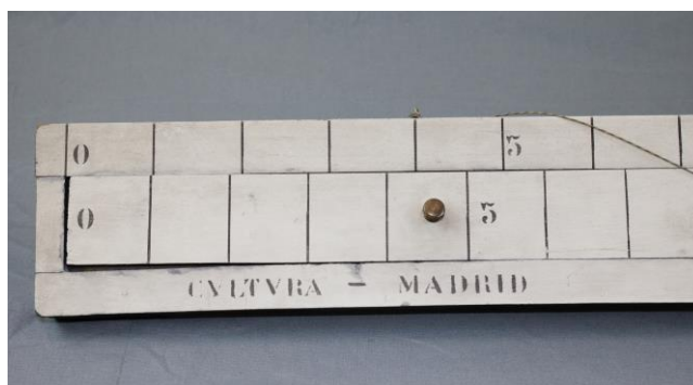
Figura 109. Modelo escolar de nonius decimal y detalle de la firma, Cultura, 1933. IES Lope de Vega (LDV/002/0034).
