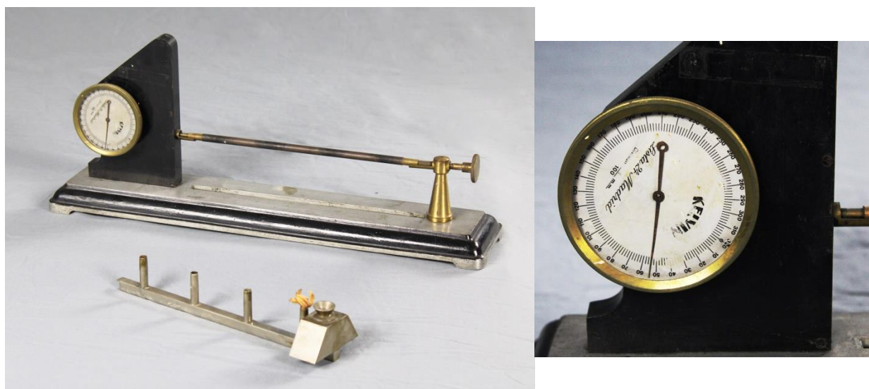
Figura 121 a y b. Dilatómetro de la casa Kelvin (1930-1950) y detalle del cuadrante. IES Lope de Vega (LDV/02/0005).
