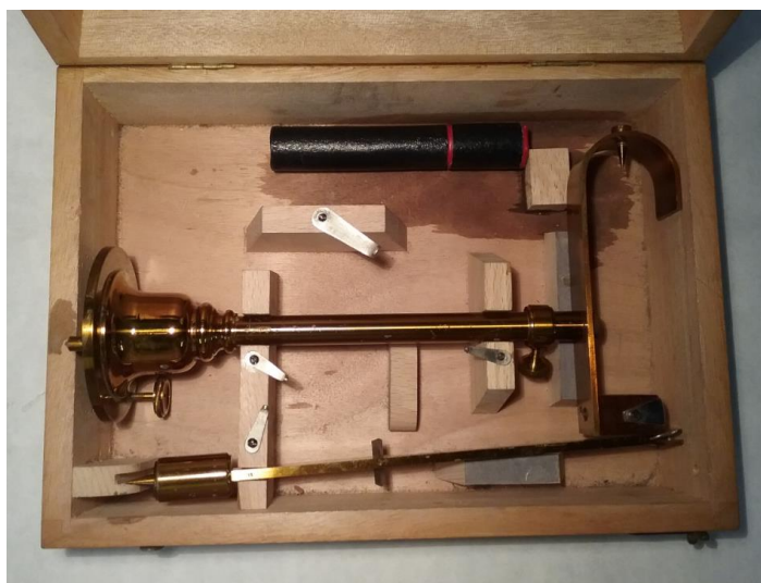
Figura 106. Balanza de Westphal, Giralt Laporta, 1933. IES Lope de Vega (LDV/006/0064).
