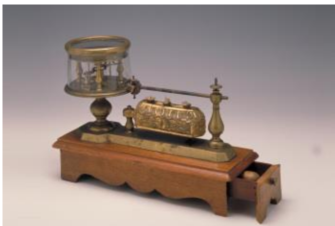
Figura 19. Dilatómetro fabricado por Diego Rostriaga para el Instituto de San Isidro (Madrid, 1770-1785). Fotografía: MUNCYT.
