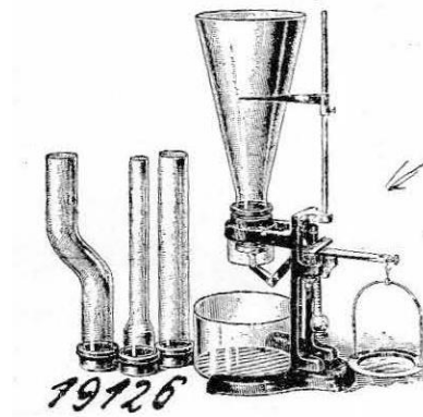
19126 APARATO DE PRESION SOBRE EL FONDO PASCAL-WEINHOLD, con juego de 4 tubos y balanza.
