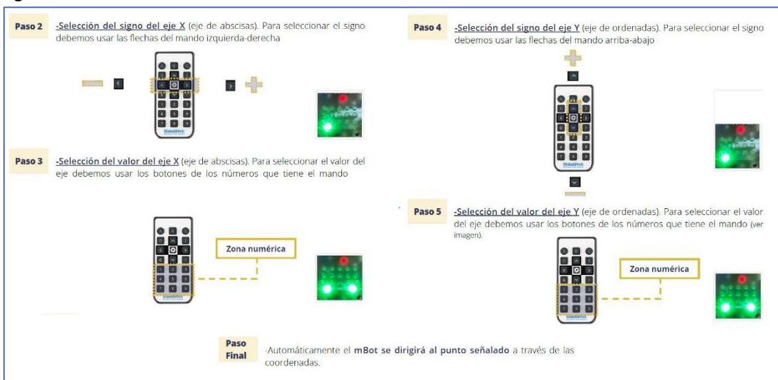
Figura 28. Envío de las coordenadas al mBot utilizando el mando a distancia.
