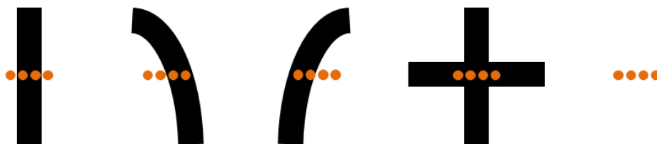
Figura 25. Diversas posiciones de los sensores en función de los colores
