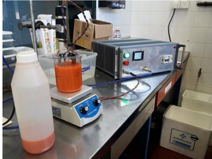
Figura 3.3. Equipo de CO calentando zumo de zanahoria fresco.
