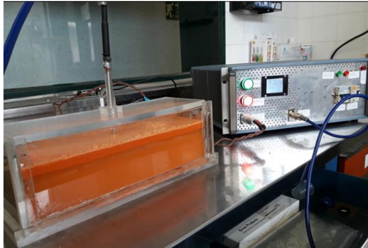
Figura 4.7. Equipo de CO utilizado para el calentamiento de zumo de zanahoria.
