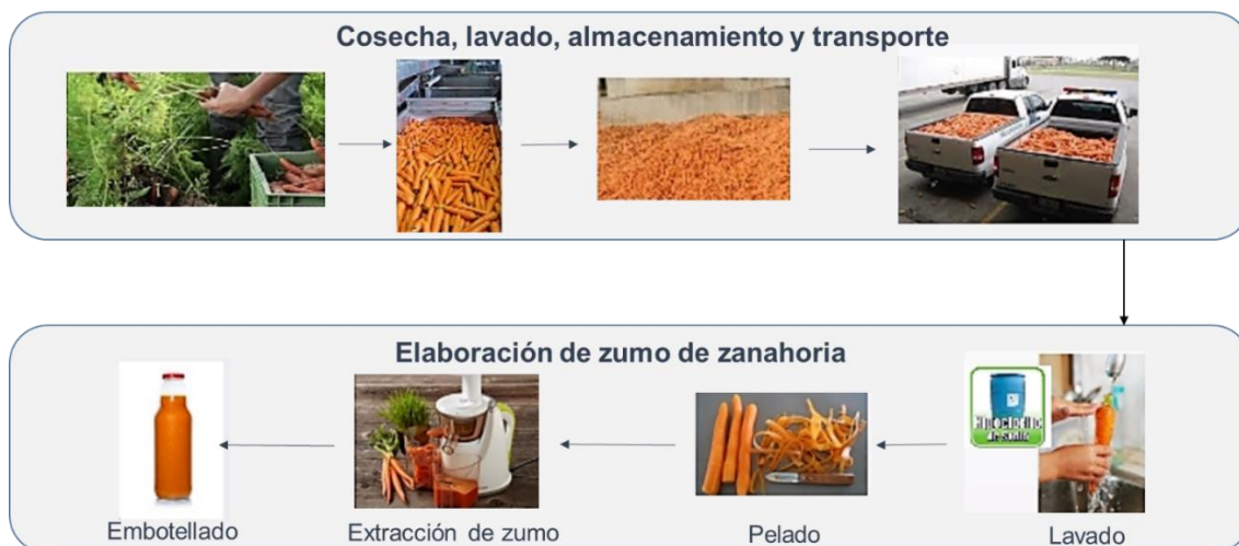
Figura 3.1. Esquema representativo de la elaboración de zumo de zanahoria.
