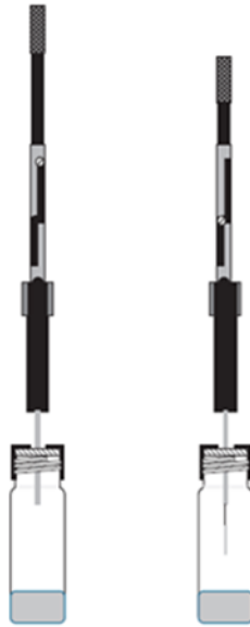
Figura 1.7. Microextracción en fase sólida (SPME) que muestra la fibra en posición baja y alta (Elmore, 2015).
