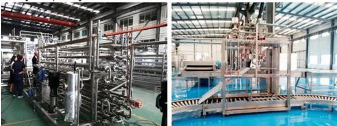
Figura 1.9. Sistema de esterilización y llenado aséptico en línea en un proceso automatizado comercial de producción de zumo de zanahoria (fuente: https://shchase.en.made-in-china.com ).
