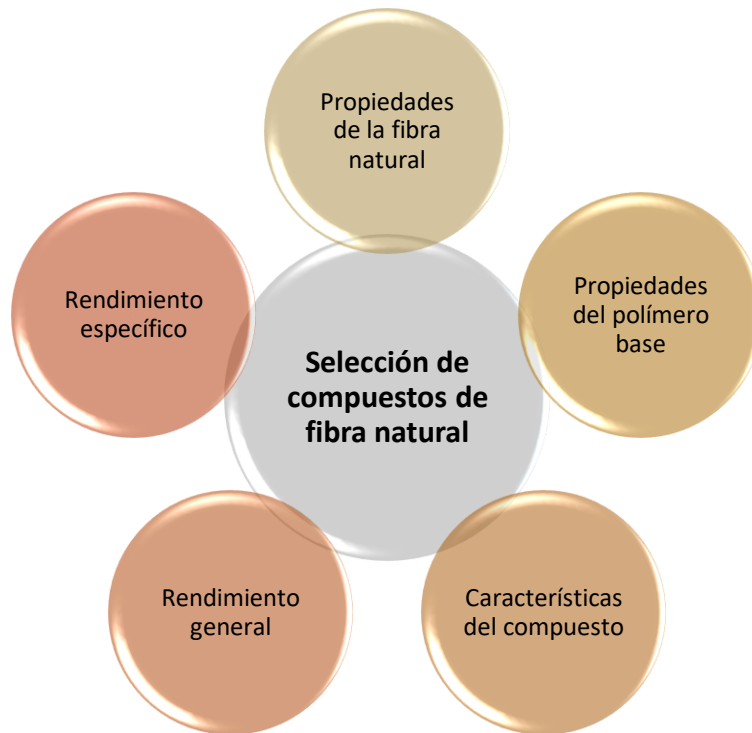
Figura 1.6. Criterios de selección de materiales compuestos de fibra natural (NFC).
