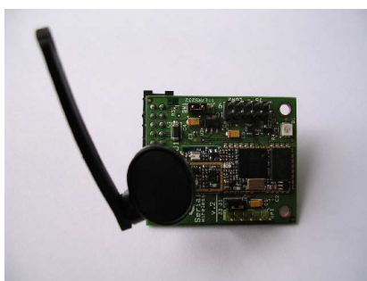
Figura 8. Sistema electrónico para comunicaciones inalámbricas: módulo Bluetooth.
