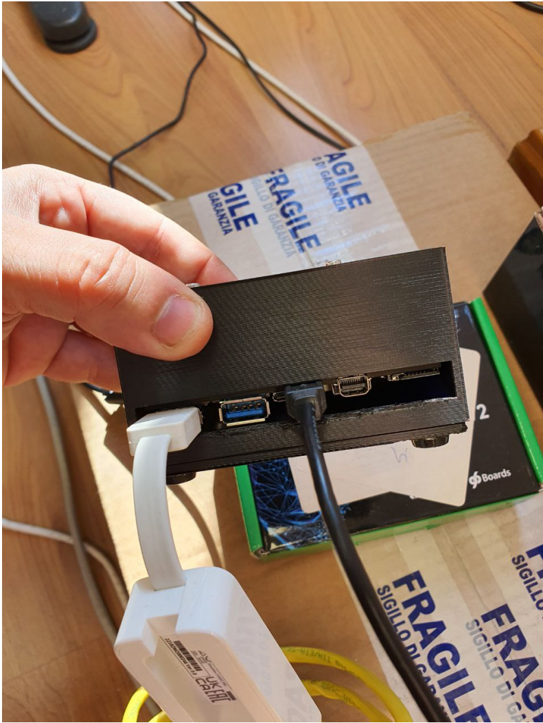
Figura F.3: Vista de las conexiones sobre la caja de la ZUS+ Ultra96-V2
