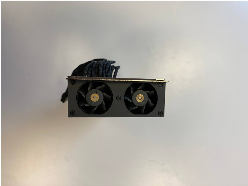
Figura D.4: Vista de la parte interior (ventiladores turbina) de la Xilinx VCK5000 Versal
