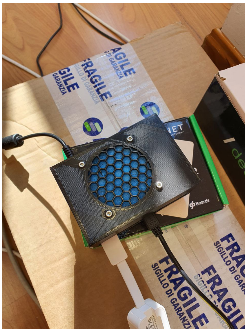
Figura F.2: Vista superior de la caja fabricada para la ZUS+ Ultra96-V2
