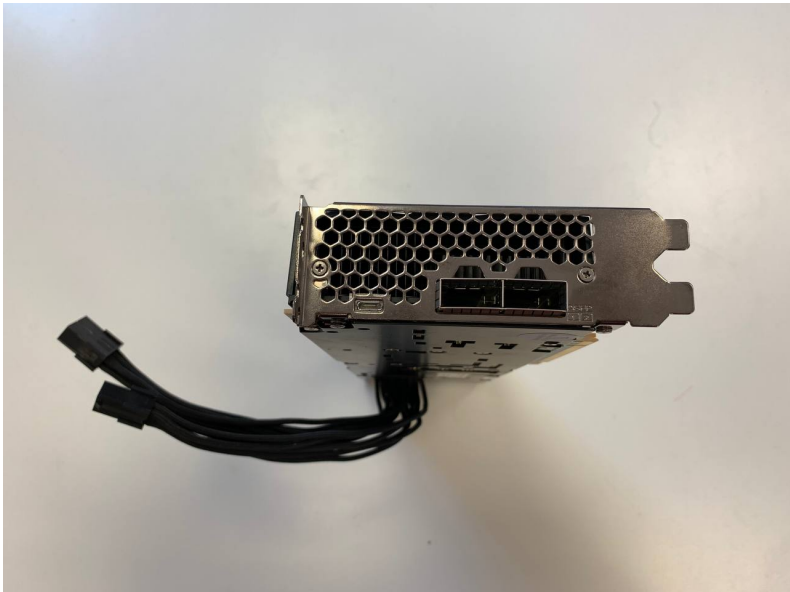
Figura D.5: Vista de la parte exterior (conexiones 2x QSFP28 (100GbE)) de la Xilinx VCK5000 Versal
