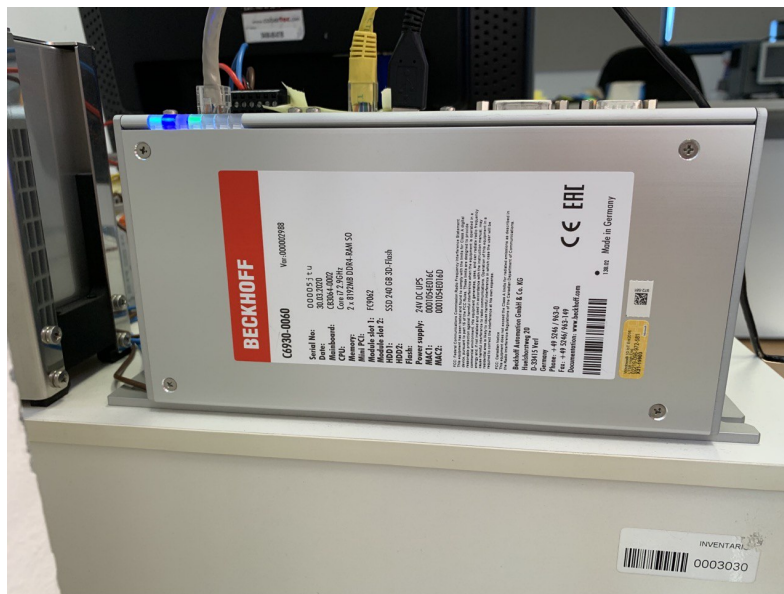
Figura H.1: Captura frontal del Beckhoff C930-0060 con la etiqueta de características
