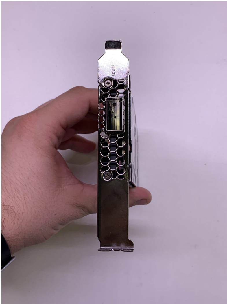
Figura E.3: Vista de la parte exterior (conexión QSFP28 (100GbE)) de la Alveo U50 Acceleration Card
