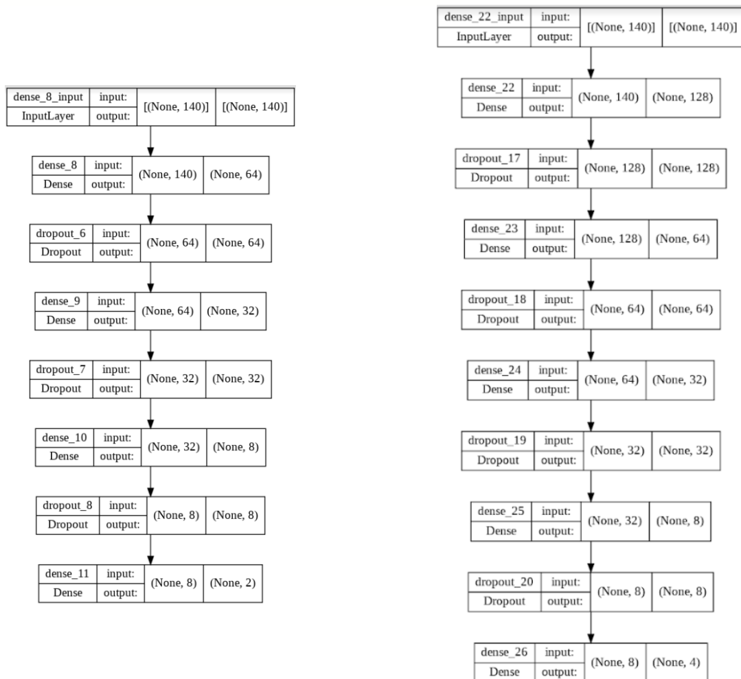
Ilustración 23. Esquema de las redes neuronales definidas para las clasificaciones del presente TFM (a la izquierda clasificación binaria, a la derecha clasificación multilabel)
