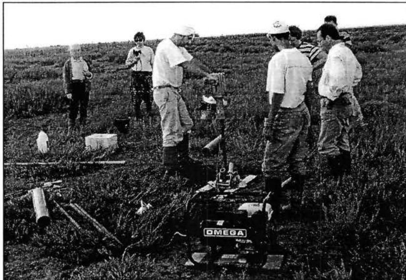
Figura 1.4. Máquina de perforación a percusión EIJKELKAMP.
