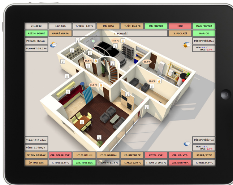
Figura 2.5: Consola centralizada Scada en una vivienda
