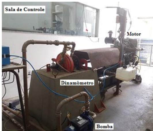
Figura 6. Motor diesel acoplado a bancada dinamométrica. Fonte: Elaboração própria
