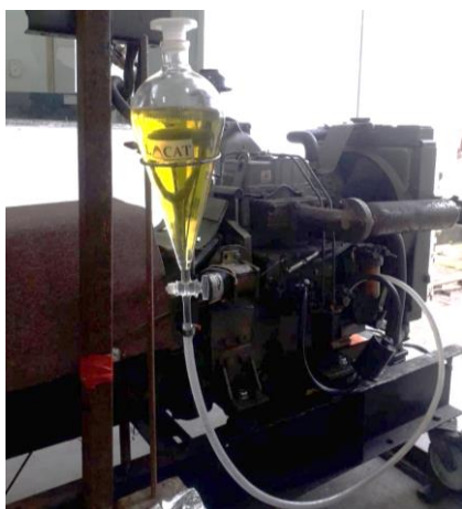
Figura 7. Reservatório de combustível para medição de consumo. Fonte: Elaboração própria.
