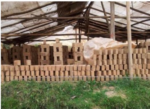
Figura 5. Secado del ladrillo. Fuente: [5]
