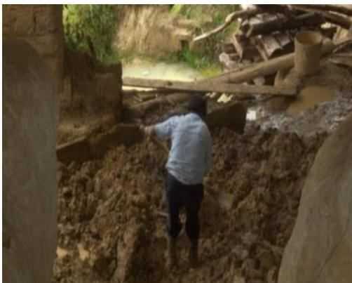
Figura 1 - Proceso de extracción manual de arcilla. Fuente: [5].
