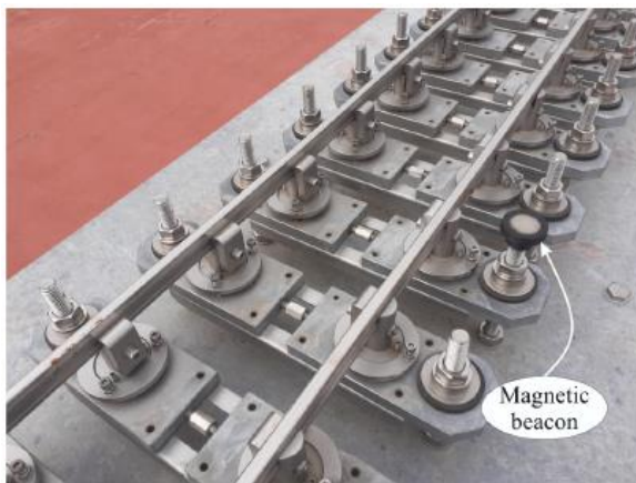
Figura 2. Mecanismo para la generación de irregularidades
