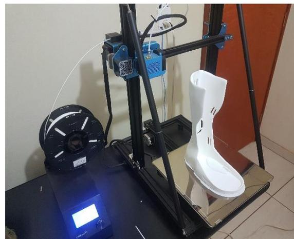
**Figura 9:** Órtese AFO estática impressa. Fonte: Elaboração própria.
