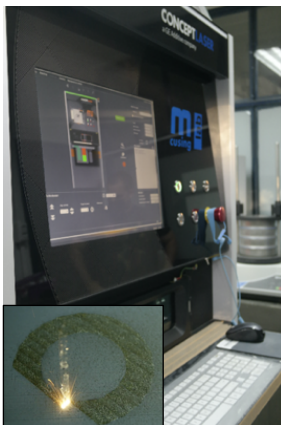
Figura 6. Sistema GE MLab-200R de impresión SLM y proceso de impresión esquina inferior izquierda.
