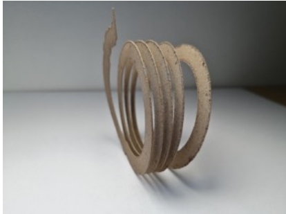
Figura 1. Argolla impresa usando sistema SGM indicando el concepto de la capa continua producida durante la impresión polar (la muestra en este caso no logró la adhesión de la capa continua) [5].
