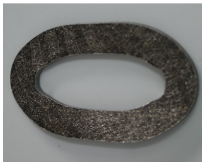
Figura 14. Argolla SLM Cartesiana después de la tracción uniaxial: 40 micrones de espesor de capa, 171 minutos de fabricación, densidad volumétrica de energía 88,3 J/mm 3 y una eficiencia de construcción de 5,3%
