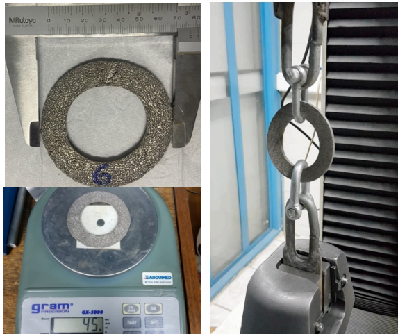
Figura 8. Dimensionamiento, masado y tracción uniaxial de las argollas impresas mediante SGM y SLM.
