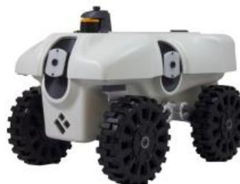
**Figura 5.** Robô TerraSentia, utilizado para a obtenção dos dados experimentais. Fonte: EarthSense.
