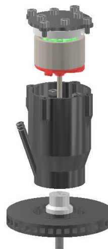
Figura 10. Atomizador rotativo – vista explodida Fonte: elaboração própria.
