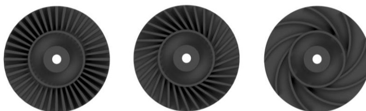
Figura 21. Rotores do pulverizador – vista semiaberta. Fonte: elaboração própria.
