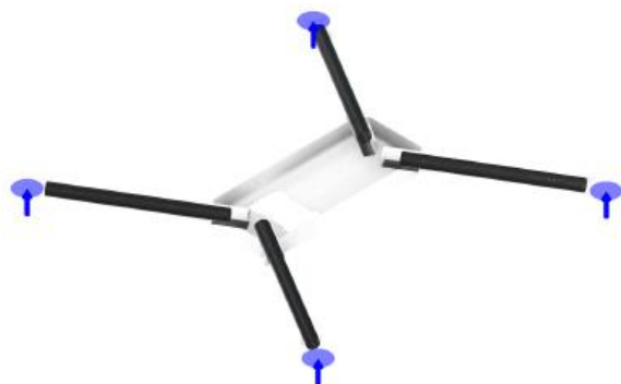
Figura 8. Força de sustentação aplicada no quadro Fonte: elaboração própria.
