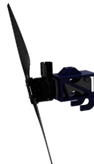
Figura 3. Suporte para ensaio do conjunto propulsor Fonte: elaboração própria.
