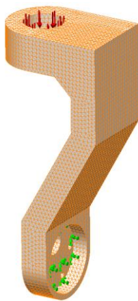
Figura 6. Cargas, sujeciones, restricciones y malla en la optimización topológica de la pieza.
