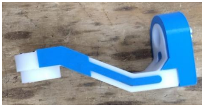
Figura 9. Pieza resultante fabricación CNC con impresión 3D.
