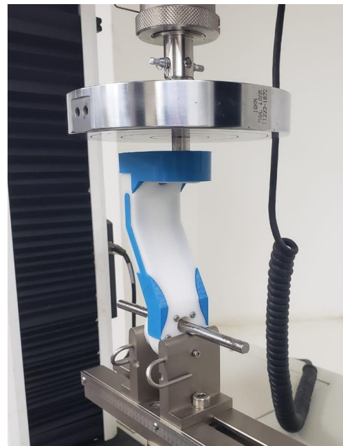
Figura 11. Montaje de la pieza en la máquina de ensayos.
