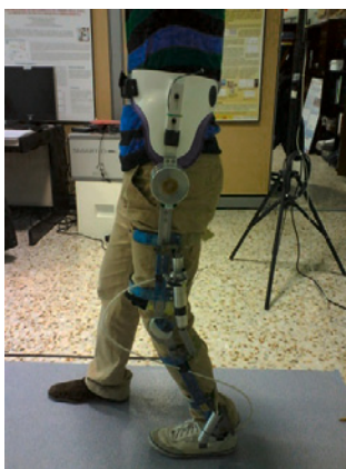
Ilustración 2. Exoesqueleto robótico Imagen cedida por el Grupo de Robótica del Instituto de Automática Industrial. CSIC.
