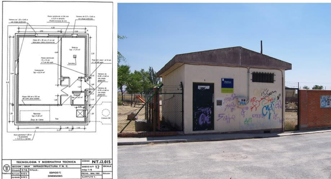
Figura 5: Planta de un edificio T2 en el manual de 1993 y ejemplar construido en Sanchidrián (Ávila), colección propia del autor.
