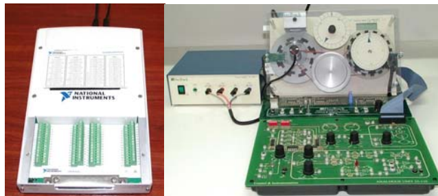
Fig 7.2 Tarjeta de adquisición de datos y planta servomotor.
