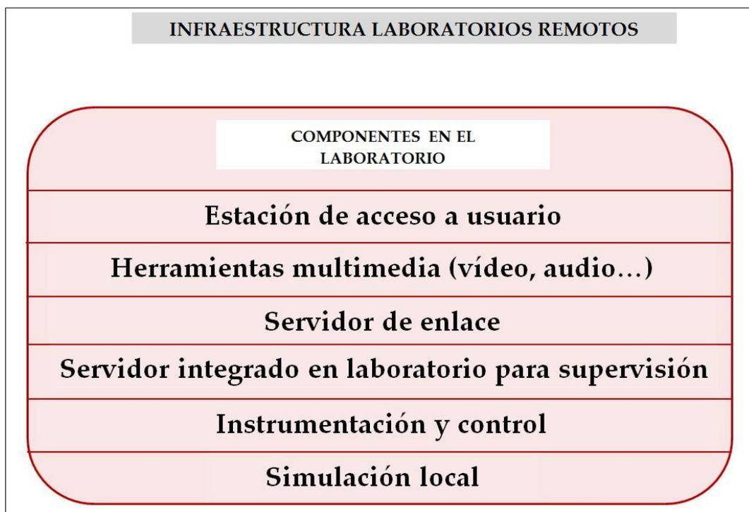
Fig. 17. Componentes en los laboratorios remotos
