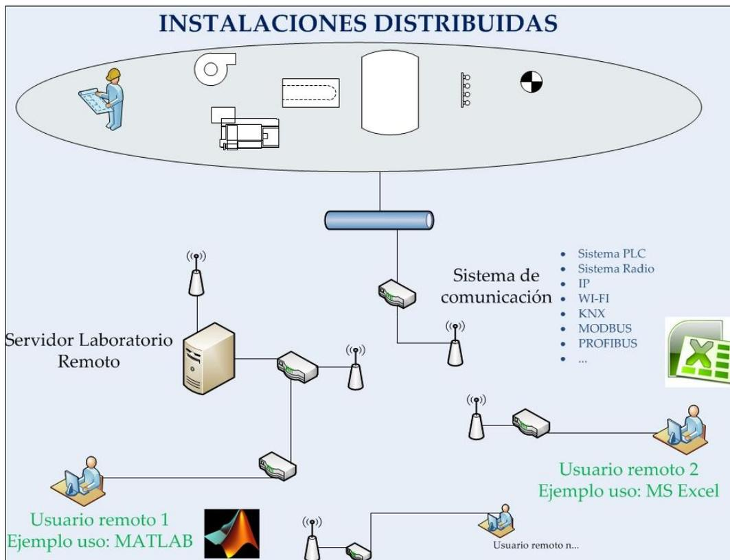
Fig. 22. Laboratorio remoto: uso de diferentes herramientas de análisis
