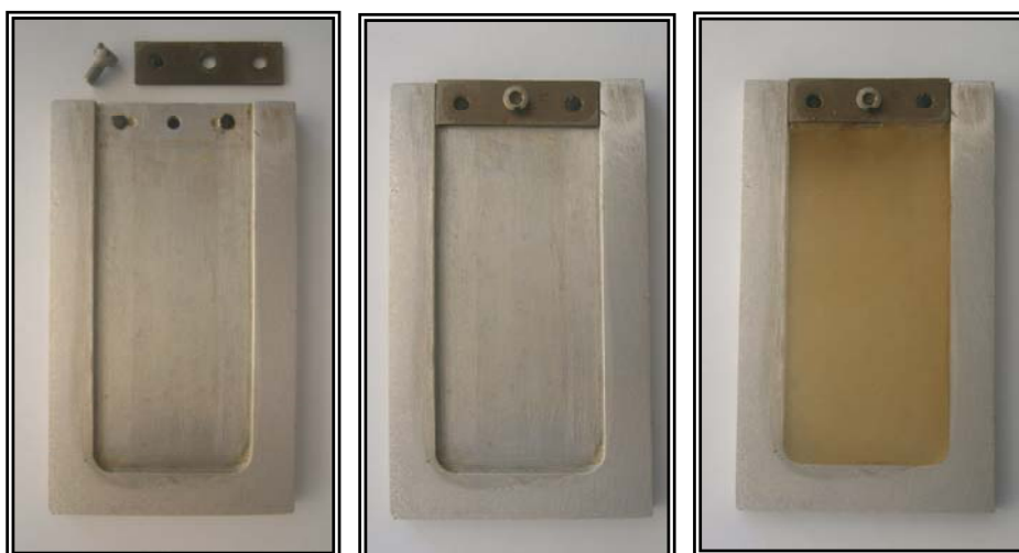
Figura 2.4 Molde desmontado, montado y posteriormente utilizado en un ciclo de curado de la resina.
