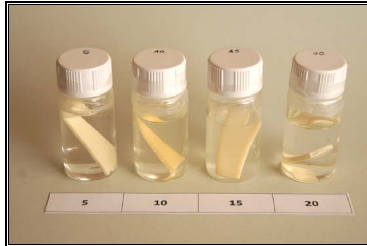
Figura 7.5 Muestras del sistema epoxi/PVAc, con diferentes porcentajes en peso de PVAc, sumergidas en acetona durante 12 meses.
