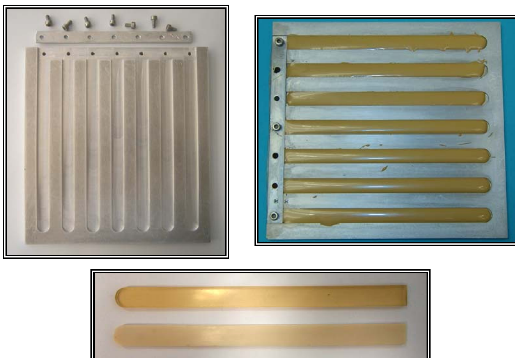
Figura 2.7 Molde de aluminio utilizado en la fabricación de probetas para realizar ensayos de tracción, desmontado y montado después de realizar un ciclo de curado. Se muestran también dos probetas mecanizadas y listas para su medida.
